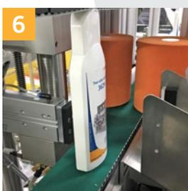
Um die Produktqualität sicherzustellen kann die Maschine mit Druck- und Etikettenanwesenheitskontrollen in Verbindung mit einer Schlechetikettenrückführung und einer Produktausschleusung ausgerüstet werden.
