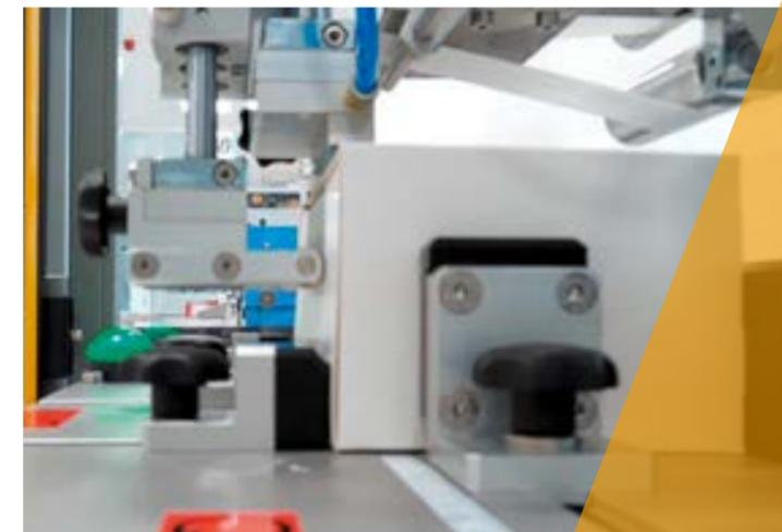
Mit der Modellreihe TNC-L werden Kartonagen und Faltschachteln mit Siegel- bzw. Verschluss-etiketten versehen. Das System ist stufenlos auf unterschiedliche Formate umrüst- und einstellbar. Den Formatbereich bestimmen wir gemeinsam mit dem Kunden. Wahlweise kann die Etikettierung auch an mehreren Stellen erfolgen – hierzu muss das Produkt in der Anlage umplatziert werden.
