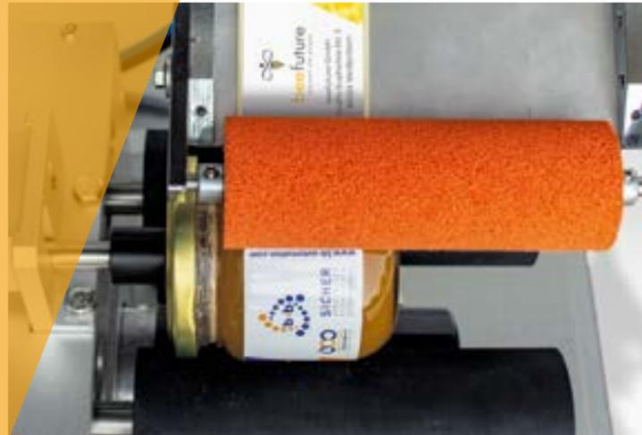
Befinden sich Vorder- und Rückseitenetiketten auf einer Etikettenrolle, kann das System auch mehrere Etiketten am Umfang platzieren. Hierbei ist der Abstand zwischen den Etiketten zueinander im Anlagenformat einstellbar.
